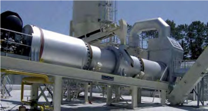
Figure 2.2 – Recyclage à chaud en centrale
