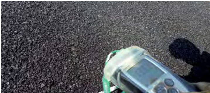
Figure 4.1 – Enrobé tiède avec recyclés en sortie de centrale Source : Université Gustave Eiffel
