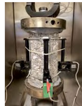
Image # 6 - Éprouvette de grave traitée instrumentée pour essai de module en traction compression directe ou fatigue
