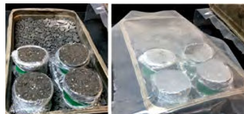
Images # 4 et 5 – Série d'éprouvettes simulant un recouvrement
